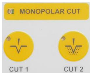
在前面板上标有黄色的 "Monopolar CUT" 控制面板中，指示灯 (2) 显示是否激活电切电流，可以使用两种不同的电流形式进行电切:
