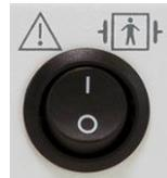
在使用电源开关（17）打开之后，设备运行准备就绪。开关上方的显示窗必须亮起绿光。
