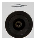
进行双极电凝时，请将器械连接线连接到插口（20）上。这根电缆上可以连接诸多双极器械。
