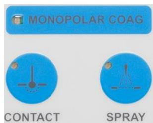
在前面板上标有蓝色的 "Monopolar COAG" 控制面板中，指示灯 (5) 显示是否激活单极电凝电流，可以使用两种电流形式进行电凝:
