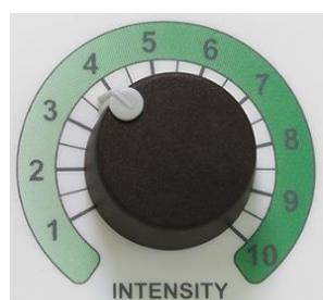
需要操作功率调节器 (7) 设置输出功率。根据所选的电流形式而定，在最大值到最大值之间进行功率设置（参见技术数据，第 9.1 章）。输出功率随旋转角度的变化而定几乎呈线性增加，下图中可以看出与每种电流类型的关系。
