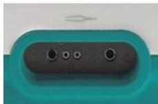
通过将连接电缆插入到设备正面（参见左上图）的接口（23）内和将脚踏开关（REF 36 01 10）与设备背面（参见左下图）的接口（38）相连，对**双极器械**进行调试。
