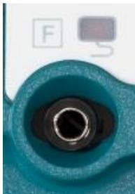
将设备前侧的中性电极接入插口（30）。可以选择连接单件式电极，或可以监控与患者接触情况的双段式中性电极。
